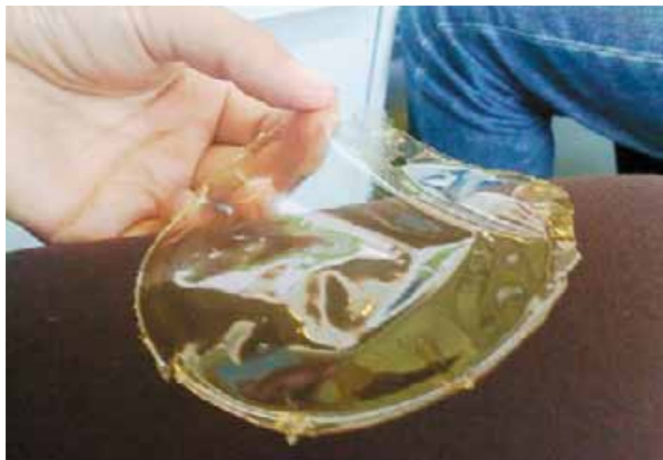
Figura 1. Membrana de quitosano entrecruzada con glutaraldehído.
